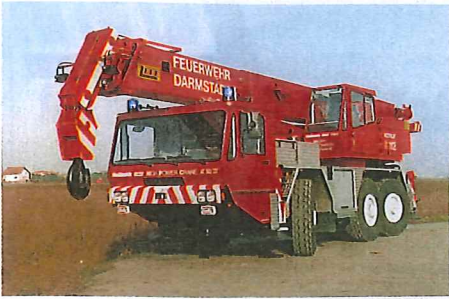
Abb. 4: Luna AT 50/34 mit zwei Motoren, 2,5 m Breite und vierteiligem Teleausleger für 36 m Rollenhöhe
