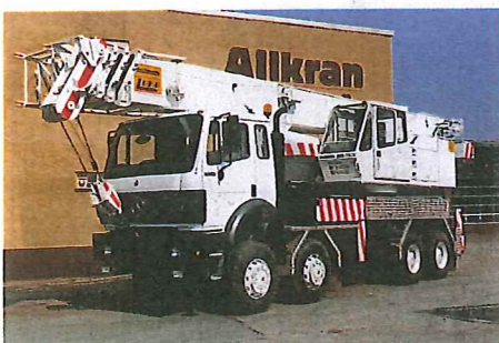
Abb. 5: Der 50 t tragende Aufbaukran Luna GT 50/34 auf einem 8 x 8-Chassis
